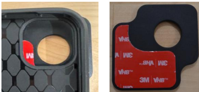
Figura 3 – Adesivo che sporge oltre il bordo della fotocamera della cover
