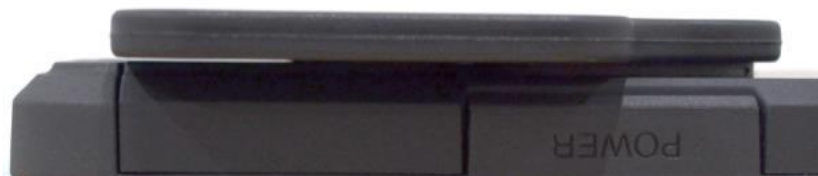
Figura 2 – Parte magnetica posizionata piatta sul retro della cover. Notare lo spazio tra la linguetta e le sporgenze della cover attorno alla fotocamera.
