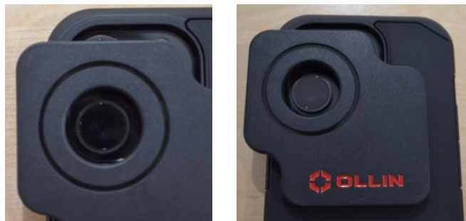
Figura 5 – Allineamento concentrico del foro con la lente.
